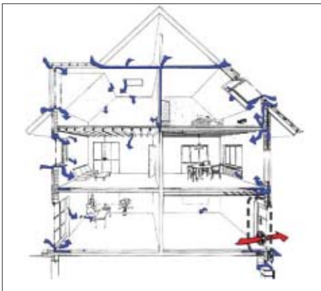
Iespējamās gaisa ieplūdes vietas ēkā
